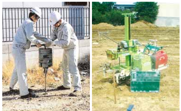
写真-1 SWS試験機の例（左が手動式、右が全自動）
